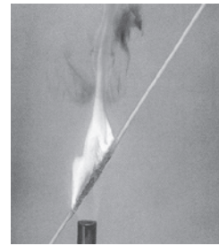
図6 従来電線 (IV) 接炎時
