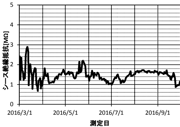
図 1 シース絶縁抵抗 実線路測定例
