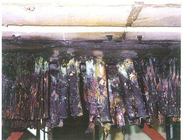
③ 試験終了後の試験体の状況(加熱側)
